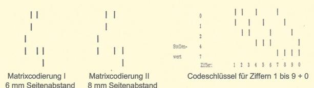
Die Strichcodierung wurde im Werner – Werk von Siemens & Halske entwickelt. Zuerst wurde in der Probephase mit Code Schlüssel I mit 6 mm Seitenabstand verwendet. Bei Inbetriebnahme der Briefverteilanlage im Postamt Pforzheim wurde ein Codeschlüssel II mit 8 mm Seitenabstand auf den Sendungen aufgebracht. Der Matrix - Strichcode II hat sich durchgesetzt und wurde von allen anderen Postämtern übernommen und codiert.
